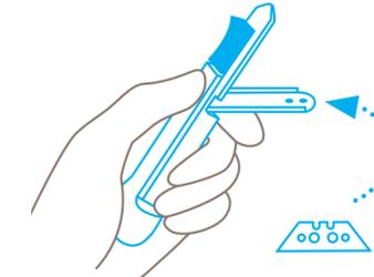
Mithilfe des Zeigefingers Klingenhaltung langsam **nach unten aufklappen**, Klinge mit der anderen Hand entnehmen und wenden oder wechseln.
