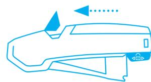
Ziehen Sie den **Klingenwechselknopf** nach oben heraus und betätigen Sie den Hebel. Klinge und Klingenhalterung treten aus dem Griff heraus.
