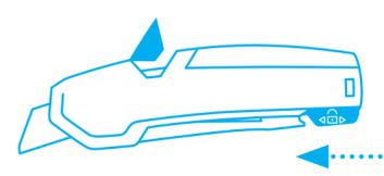
Fixieren Sie den Hebel mit der Sicherung und drehen Sie den Griff so, dass die **transparente Klingendeckung nach oben** zeigt.
