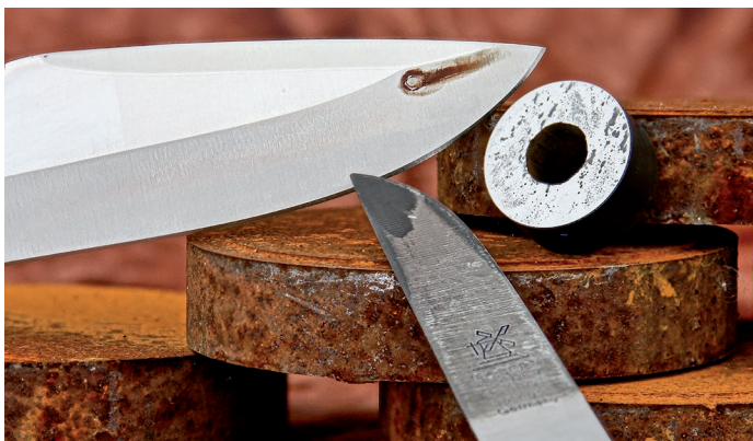
Die Kontrollgruppe war 48 Stunden ungeschützt dem Salzwasser ausgesetzt: Der 440A-Stahl (große Klinge) litt nur leicht, Carbon- und Vergütungsstahl zeigen sich deutlich „angefressen“.
