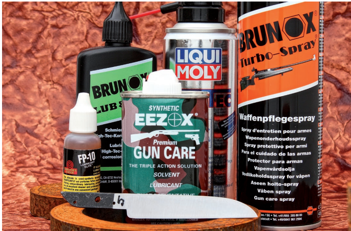
Ölige Retter: Ohne Schwächen zeigten sich Brunox Lub&Core und Eezox. Die übrigen Helfer ließen punktuelle Anrostungen durchkommen.
